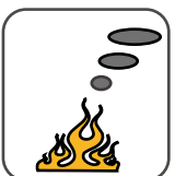
Low Smoke Emission IEC 61034-1&2 EN 50268-1&2/NF C32-073
