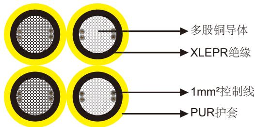
导体: VDE 0295/IEC 60228标准Class 5/Class 6多股铜导体。
