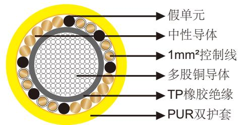
导体: VDE 0295/IEC 60228标准Class 6/Class 5多股铜导体。
