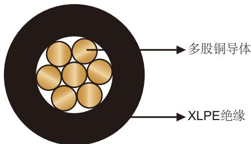
导体: ASTM B多股裸铜导体。
